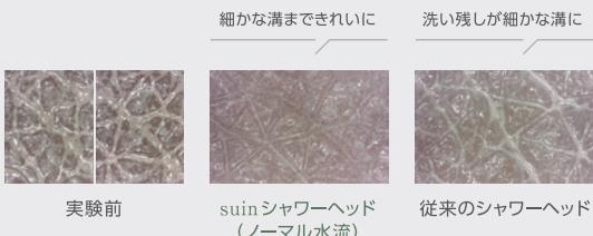
【試験内容】腕部にリキッドファンデーションとクレンジングオイルを混ぜ合わせたものを塗り10秒間吐水した後の状態を撮影 流量：7±0.1L/min 水温：14±1°C 距離：20cm
