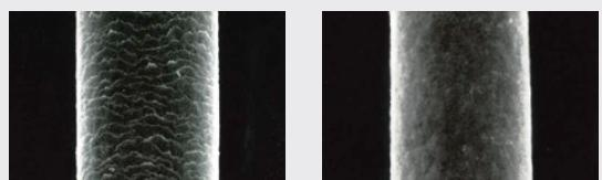
残留塩素濃度=1mg/L 浸漬時間=約4時間
